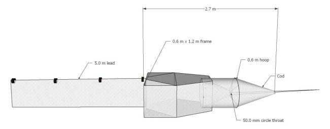
Figure 12. Schematic of mini modified fyke net
